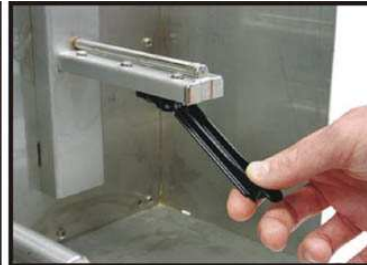
3. Pociągnij i wyprostuj uchwyt regulacji rolki papieru.
