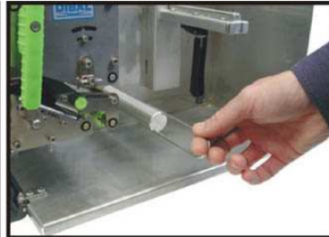
2. Wyciągnij z trzpienia widełki mocujące papier podkładowy.
