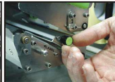
3. Kręć gałką regulacji czujnika, aż czujnik znajdzie się na przerwie między etykietami.
