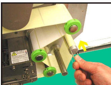
10. Załóż papier podkładowy na rolkę zwijającą i zabezpiecz widelkami.
