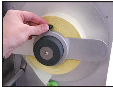
2. Załóż nową rolkę papieru i przykręć ponownie zabezpieczenie.
