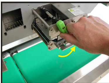
4. Przekręć zieloną dźwignię papieru w lewo (otwarcie).
