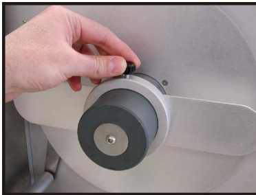
1. Odkręć śrubę zabezpieczenia rolki papieru.
